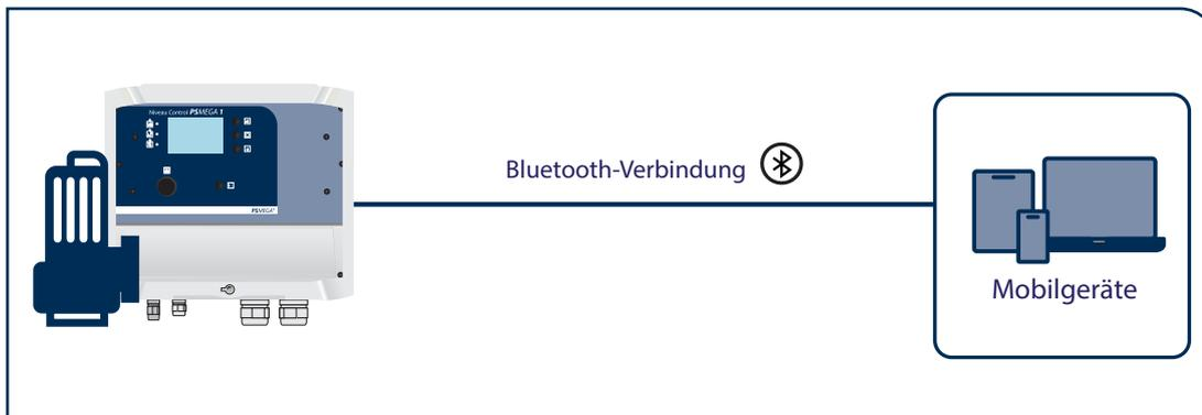
Das optionale Bluetooth-Modul erlaubt es Ihnen alle Funktionen und Einstellungen drahtlos zu bedienen, einfach und klar Strukturiert werden Ihnen sämtliche Funktionen zur Verfügung gestellt. Somit können Sie z.B. mit einer schlecht zugänglichen Steuerung komfortabel in Kontakt treten. Daten und die Parametrierung können auf Ihrem Mobilgerät gespeichert und auf andere Geräte der MegaSerie übertragen werden
