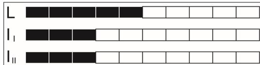
Im oberen Bereich des Displays befinden sich ein Bargraph für den Pegel (L) und zwei Bargraphen für den Strom der Pumpen (I) In der Grundstellung des Displays werden zusätzlich unter den Balkenanzeigen der Pegel und die Betriebsstunden in Ziffern angezeigt. Ist die Pumpe in Betrieb, wird der Motorstrom angezeigt. Sind irgendwelche Störungen aufgetreten, werden sie im Wechsel in der unteren Zeile des Displays angezeigt.
