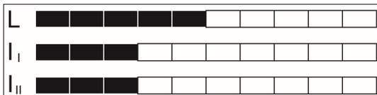
Um eine sinnvolle Auflösung der Balkenanzeigen zu ermöglichen, kann hier der maximale Wert der jeweiligen Anzeige eingestellt werden. Wenn in dem Menüpunkt AUTO gewählt wird, wird automatisch der Maximalwert des jeweils eingestellten Niveaus oder des max. Stroms, verwendet.
