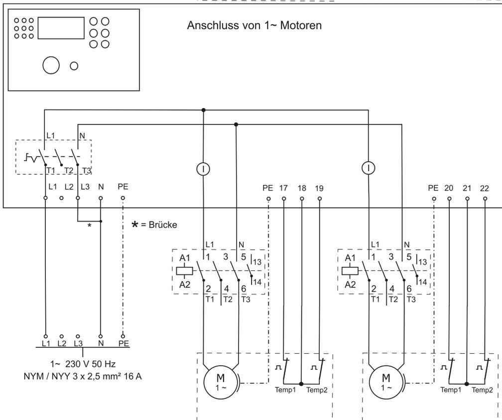
**Achtung!** Bei Anschluss von 1~ Motoren beträgt die maximale Anschlussleistung **2,4 KW!**
