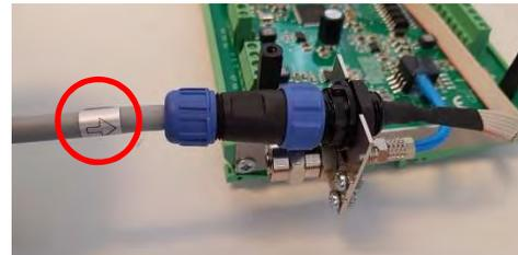
Der Pfeil auf den Aufkleber am Kabel muss in Richtung Hutschienenteil zeigen.
