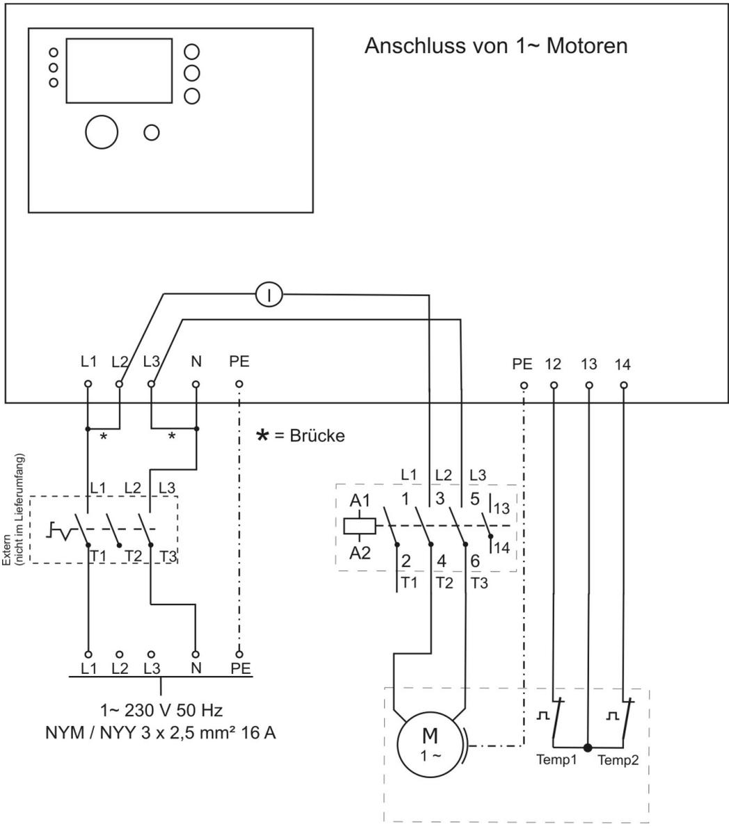
**Achtung!** Bei Anschluss von 1~ Motoren beträgt die maximale Anschlussleistung **4 KW!**
