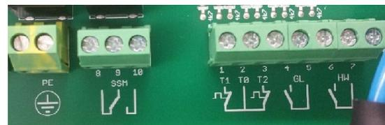
An den Klemmen 4/5 (GL) wird der Schwimmerschalter angeschlossen, der den Ein- und Ausschaltpunkt der Pumpe bestimmt. Mit dem rechten Regler (Nachlaufzeit) lässt sich bestimmen wie lange die Pumpe noch läuft, wenn der Ausschaltpunkt unterschritten wurde. An den Klemmen 6/7 wird der Schwimmerschalter für den Hochwasseralarm angeschlossen.
