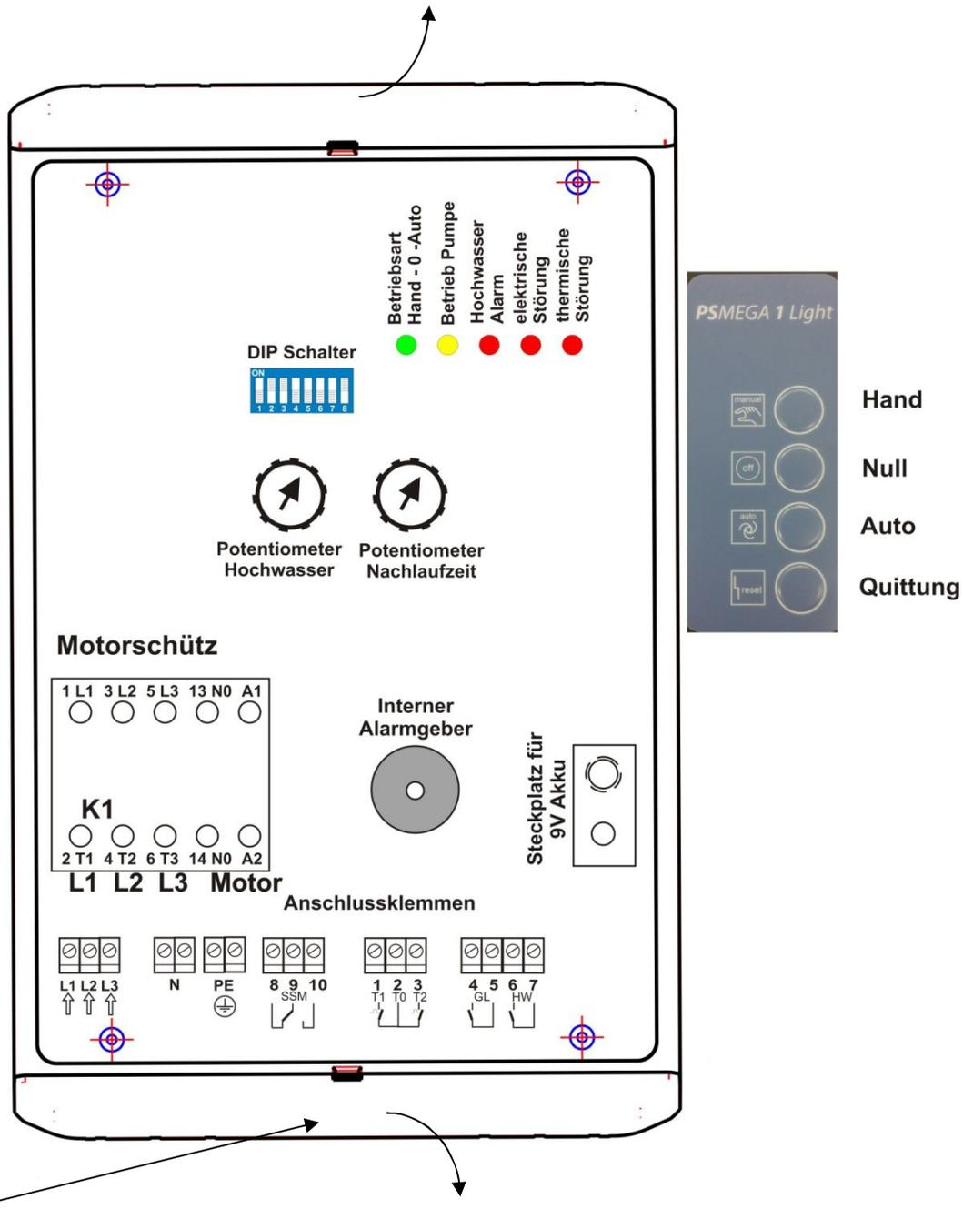
Zum Öffnen des Deckels kann ein Schraubendreher oder ein ähnlich geeigneter Gegenstand zu Hilfe genommen werden. Dazu wird der Schraubendreher oder Ähnliches unten oder oben in die dafür vorgesehene Öffnung geführt und leicht nach oben oder unten gehobelt. Der Deckel kann durch lösen beider Teile auch ganz abgenommen werden.
