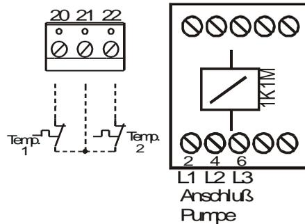
Die Anschlüsse L1, L2, L3 der Pumpe werden direkt am Motorschutz aufgelegt. Der Schutzleiter wird an der verbleibenden PE Klemme 20/21, der Bimetallkontakt der die Pumpe erst nach der Quittierung freigibt, wird an der Klemme 21/22 auf der oberen Platine angeschlossen (wenn Temp. 1 nicht angeschlossen wird, muss die thermische Störung 1 im Menü abgeschaltet werden).
