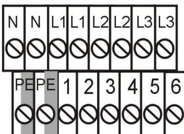
**Netzanschluss (3 ~) L1, L2, L3, N, PE (Bild 1a im Anhang)**
