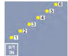
Hier leuchtet die entsprechende LED bei Schließung des jeweiligen Digitaleinganges. Bei Invertierung mittels DIP-Schalter (Punkt 5.3) leuchtet die LED 1 bei geöffnetem Eingang
